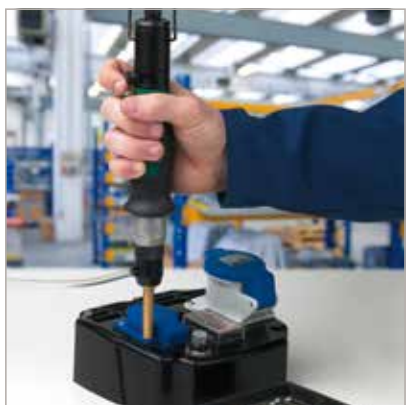
Atornillador personalizado con dispositivo de aspiración de los tronillos, útil con los tornillos INOX no magnetizables.
